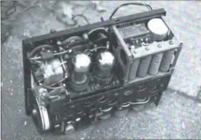
Links boven is de antenne afstemspoel L-5 zichtbaar. Daarnaast de zendeindbuis V-2 (7C5) en daarnaast de zenderoscillator/ontvanger LF-versterkerbuis V1 (7H7). Rechts boven is de netvoeding met de vier metaaloxidede gelijkrichters.
